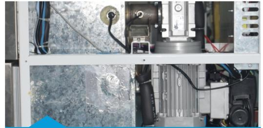
传动系统,搭载品牌一体化电机和海川定制化变频器,运行稳定,静音,适应冰淇淋机频繁启停,瞬间高负载的特性,过载保护,延长使用寿命
